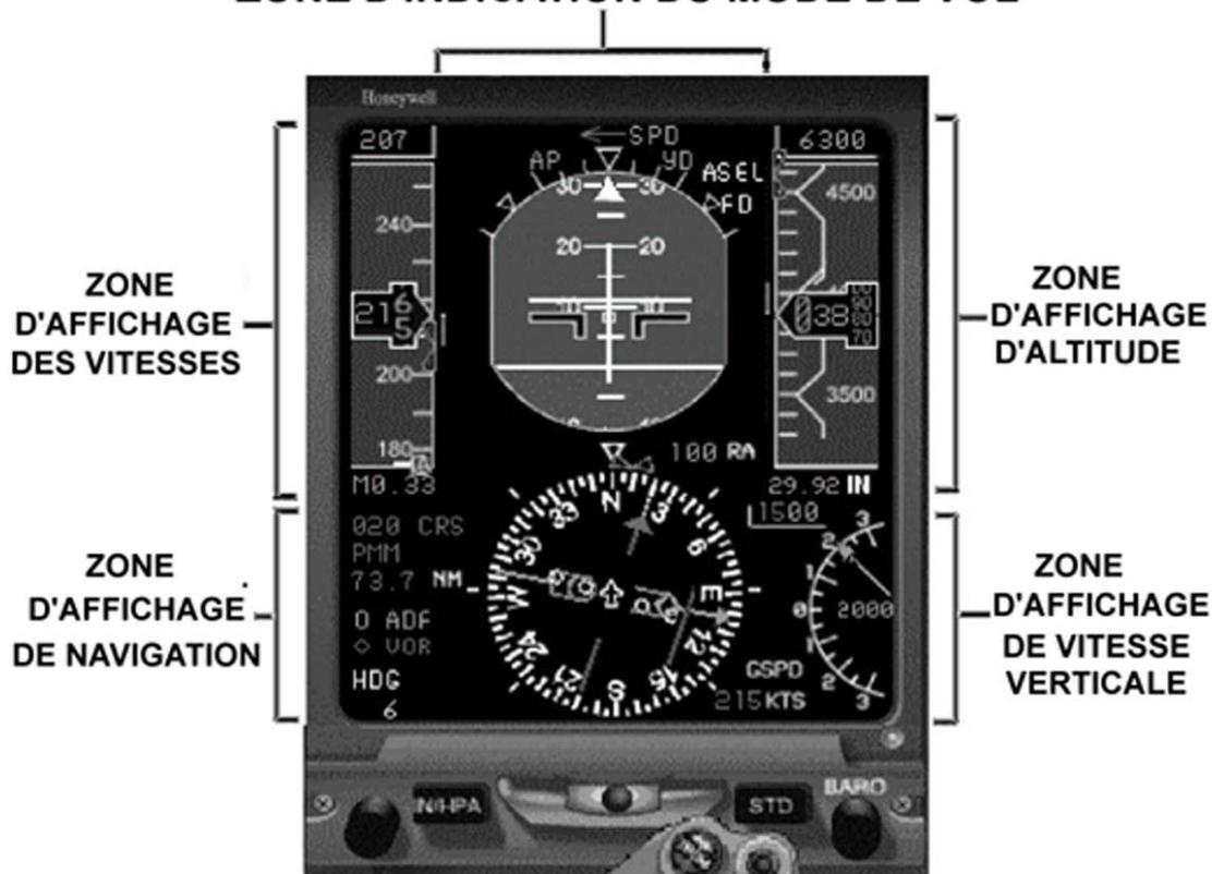
Le PFD ou Indicateur primaire de vol, est destiné à incorporer les instruments de vol courant (attitude, vitesse air, altitude, vitesse verticale, et cap) dans un seul et même écran. Le PFD affiche les bases de navigation associées au mode de vol choisi, et des repaires sélectionnés.
