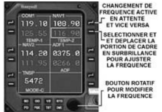
Pour déplacer la fréquence présélectionnée et la rendre active, appuyer sur le bouton curseur d'activation à côté de la fréquence active située au-dessus. La fréquence active et la fréquence présélectionnée, vont inverser leur position. La même procédure est utilisée pour COM1, NAV1, NAV2, et ADF. Le code transpondeur est modifié de la même manière, mais il n'y a pas de fréquence présélectionnée en attente.
