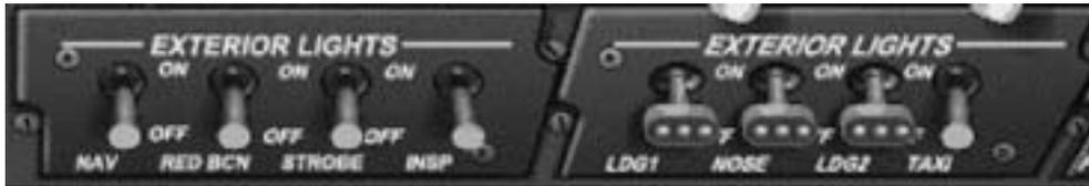
En appuyant sur les interrupteurs à bascule, les différents éclairages extérieurs de l'appareil seront allumés (ON) ou éteints (OFF).
