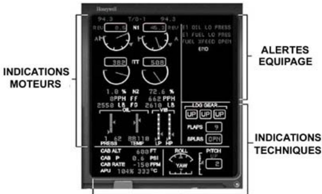
L'EICAS reste éclairé et visible en permanence, même si le commutateur des moyens radio est sur off, et affiche les renseignements visibles ci-dessus, divisés en trois sections :
